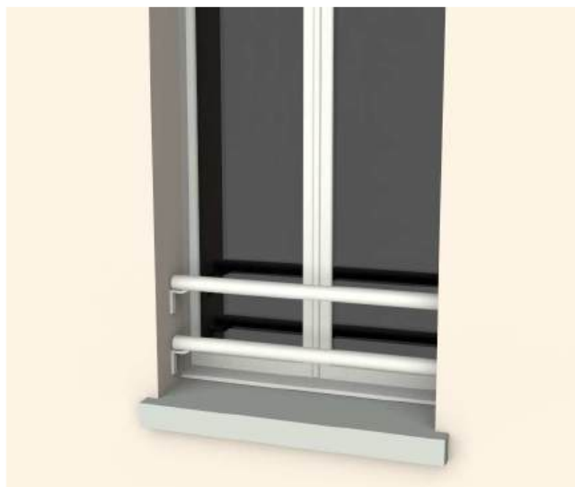
Barres d'appui posées entre tableau de fenêtre. (allège minimum 600mm)
